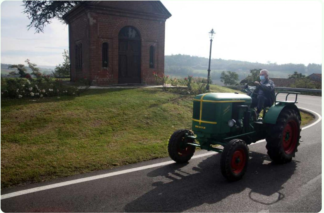
A partire dal 1934 viene prodotto il Deutz F2 M315, nel 1935 nacque il Deutz F3 M317, mentre nel 1936 viene lanciato il Deutz F1 M414, con motore monocilindrico, una potenza di 11Hp e raffreddamento ad acqua. Soprannominato il trattore del popolo, darà l'input decisivo alla meccanizzazione delle piccole aziende agricole, e sarà costruito fino al 1951. Segue la produzione della trattore con motore raffreddato ad aria fino al 1959.
