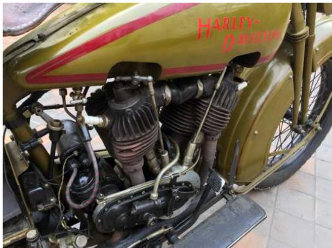
valvole di aspirazione meccaniche, in contrapposizione alle valvole di aspirazione "automatiche" usate sui precedenti V-Twins. La cilindrata è passata a 49,48 in<sup>3</sup> (811 cm<sup>3</sup>).
