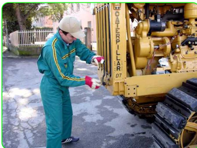
bisogna provvederne l'avviamento, operazione che avviene con l'ausilio di un piccolo motore bicilindrico Hyster a benzina con avviamento a manovella, la cui messa in moto è alquanto laboriosa.
